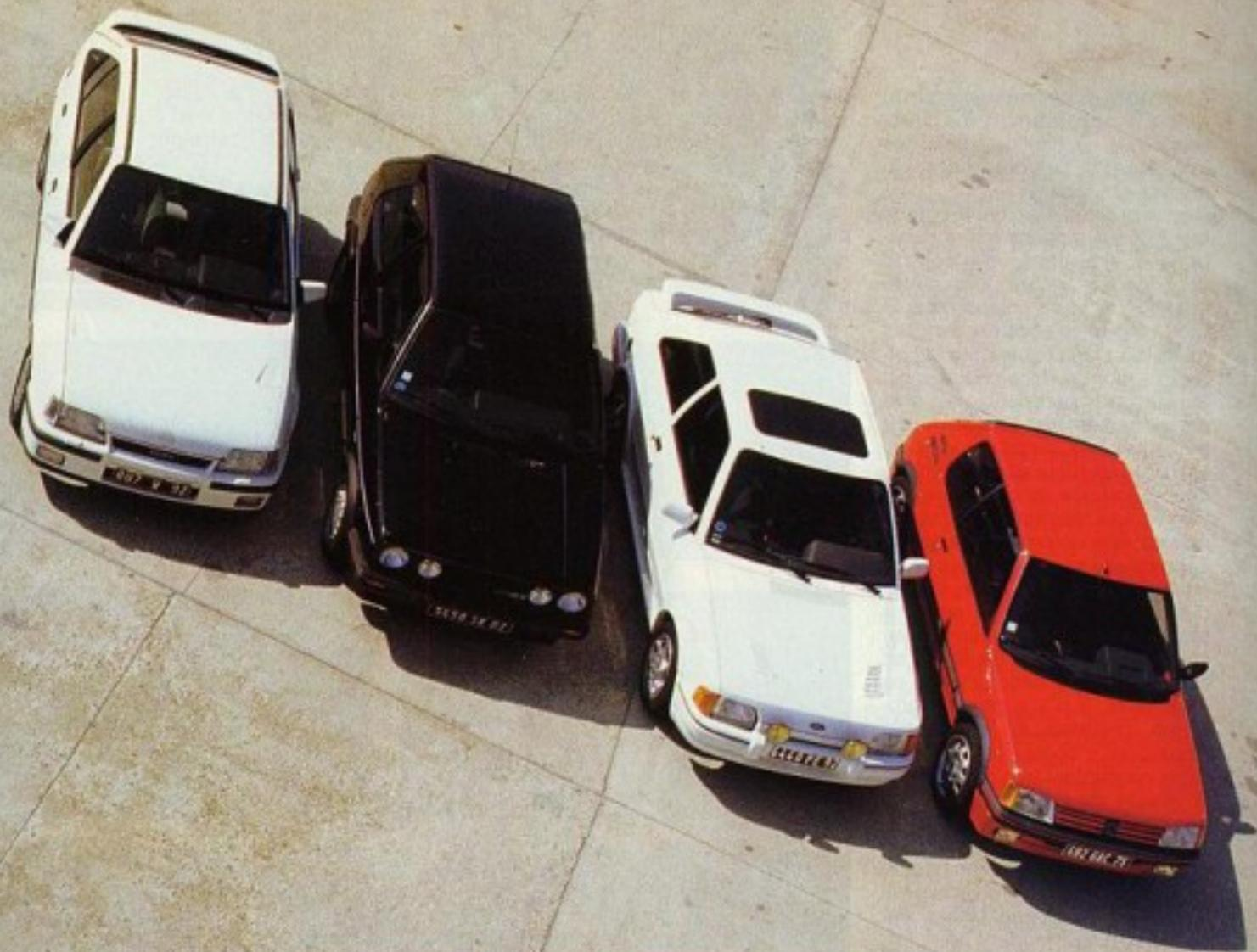
Deux doctrines en présence pour se procurer des chevaux : sophistication technologique pour VW avec son 16 soupapes et pour Ford avec son turbo refroidi par eau, contre simplicité pour Opel et Peugeot, qui ont tout simplement opté pour une augmentation de cylindrée. Finalement, les résultats sont étonnamment voisins.
